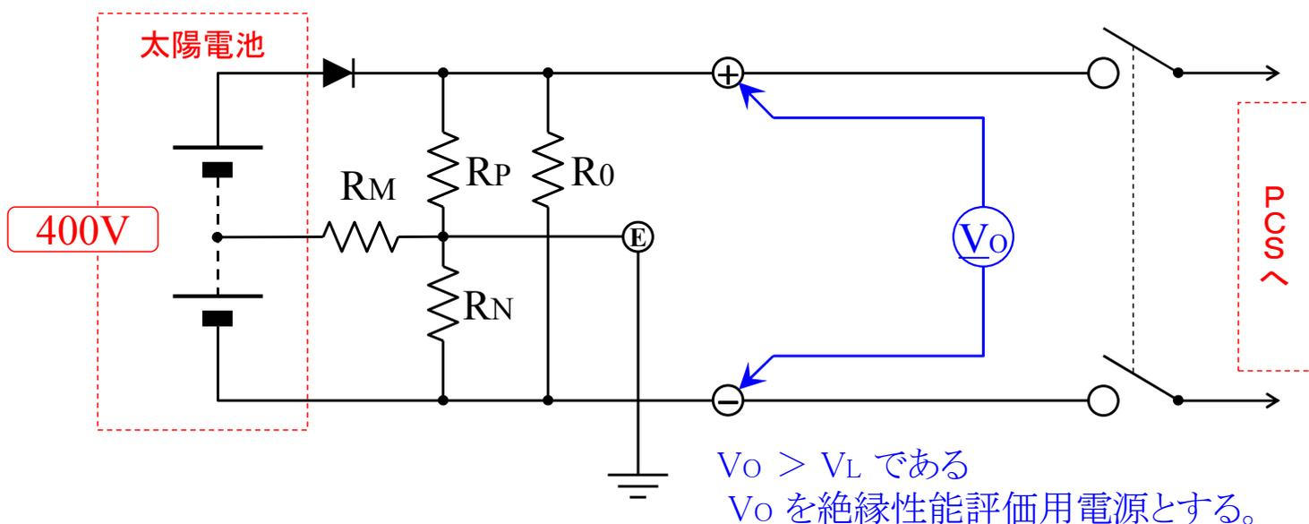
手順 3 片線地絡 (正・負両極の対地間短絡) 電流を交互に測定する
