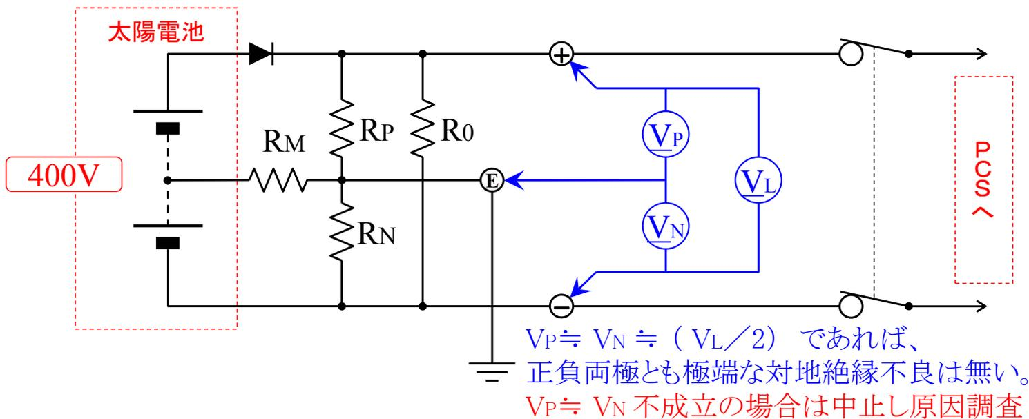
手順 2 接続箱 または スtring ごとに開放して電池電圧を測定する
